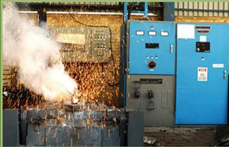
کوره ۲۵۰ کیلووات، ۵۰۰ کیلوگرم شهرک صنعتی سنگزی
