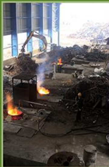
کوره ۲۷۵۰ کیلووات، ۷۰۰۰ کیلوگرم شهرک صنعتی کوهپایه
